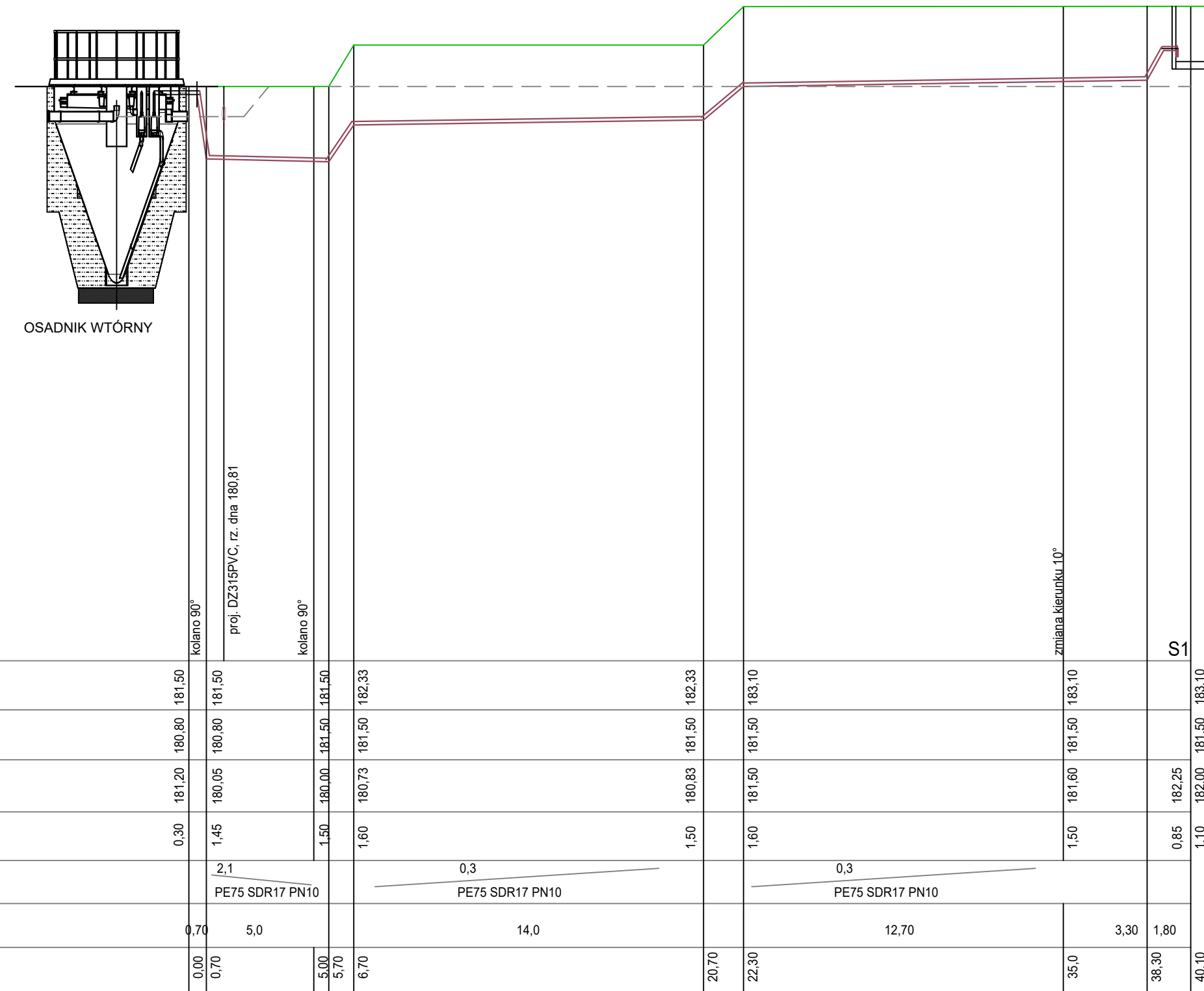
Rurociąg recyrkulacji z osadnika wtórnego
